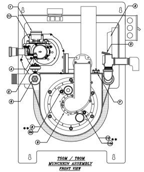
\*\* THE LOCATION OF THE HOT SURFACE IGNITOR AND FLAME RECTIFICATION PROBE IS REVERSED FOR ALL HA MODELS
